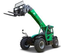
Montacargas para terrenos difíciles con brazo telescópico
