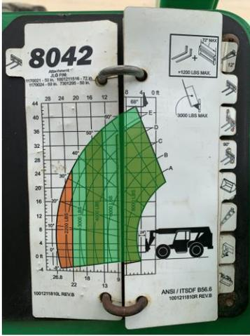
Un palé de bloques de concreto pesa alrededor de 3000 lb (1381 kg). El área verde resaltada en cuadro de carga a la izquierda muestra el área de capacidad segura para esta carga.
